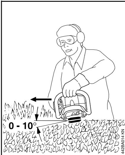
Schneidmesser in einem Winkel von  $0^\circ$  bis  $10^\circ$  ansetzen – aber waagrecht führen.
